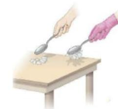
**Figura 2** Per caricare il cucchiaino per strofinio occorre indossare un guanto di materiale isolante.
